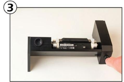
3 Schalten Sie das Licht der FillStation™ ein. Das Licht schaltet sich nach ein paar Minuten automatisch aus..
