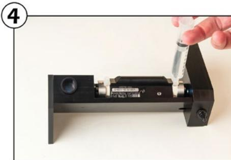
4 Achten Sie darauf, dass die Zelle stets sauber und trocken ist. Nutzen Sie dazu Druckluft und Aceton. Befüllen Sie die Zelle nur über die untere Einlassöffnung mit einer Luer-Spritze.
