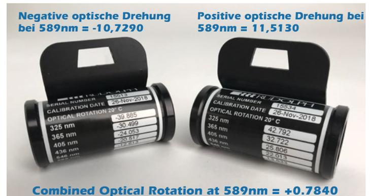
Rudolph empfiehlt dringend die Verwendung von Quarz-Kalibrierstandards mit drei Rotationswerten oberhalb, unterhalb und in der Nähe der zu prüfenden Probe, um die FDA-Bestimmungen zum "Sample Bracketing" und die jüngsten EP-Kalibrierrichtlinien zur Linearität zu erfüllen. Jeder Quarzstandard ist von einer akkreditierten unabhängigen Stelle (NVLAP) zertifiziert und auf NIST rückführbar.
