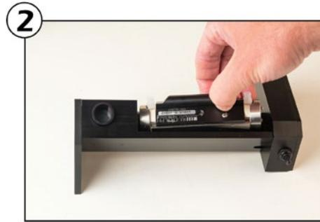
2 Setzen Sie eine Polarimeterzelle mit 2,5 mm oder 5,0 mm Durchmesser in die Rudolph FillStation™ ein
