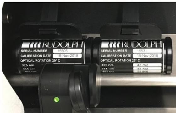
Jede Quarzplatte wird für die Kalibrierung durch das Gerät direkt vom Touchscreen aus positioniert. Die Kalibrierung ist somit vollständig automatisiert und erfordert kein Handling der Quarzkontrollplatte.
